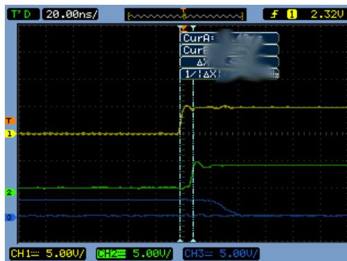
Messung der Minimalen Hold-Time. Zulässige Hold-Time wurde gerade unterschritten, Kanal 1:  $D_{in}$ , Kanal 2: Clock, Kanal 3:  $D_{out}$ . Die Hold Time kann 0 oder sogar negativ sein. Details im Bild wurden versteckt.
