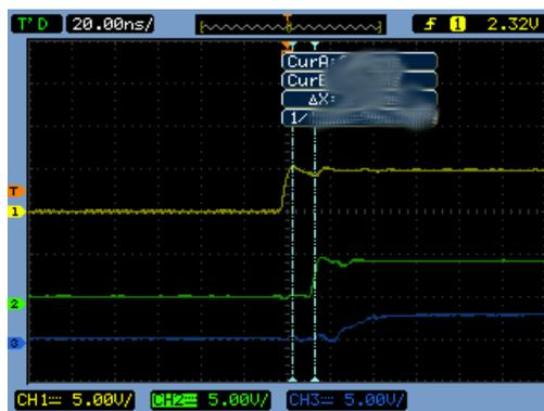
Messung der Minimalen Setup-Time, Kanal 1:  $D_{in}$ , Kanal 2: Clock, Kanal 3:  $D_{out}$ . Details im Bild wurden versteckt.
