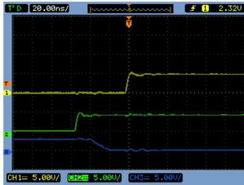
Unkritischer Fall: Kanal 1:  $D_{in}$ , Kanal 2:  $D_{out}$ , Kanal 3:  $D_{out}$ .  $D_{out}$  übernimmt den Low-Pegel von  $D_{in}$ .  $D_{in}$  ist schon lange Zeit auf Low. Taktflanke ist sehr weit vor dem Wechsel in  $D_{in}$ .
