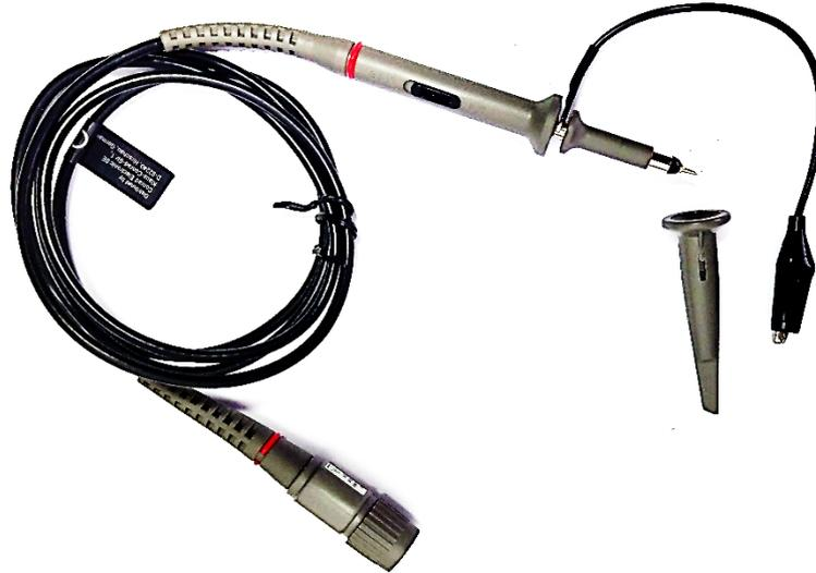
**Im Versuch verwendeter Tastkopf mit Masseklemme und abgezogener Klemmvorrichtung für die Prüfspitze. Der Trimmkondensator befindet sich im BNC-Anschlussstück. Der 1:1/10:1-Umschalter ist der schwarze Schieber im Griffstück.**
